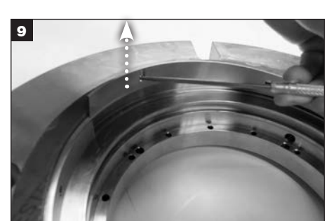
Fjern alle fjærer fra glandfjærens hull og avhend.
